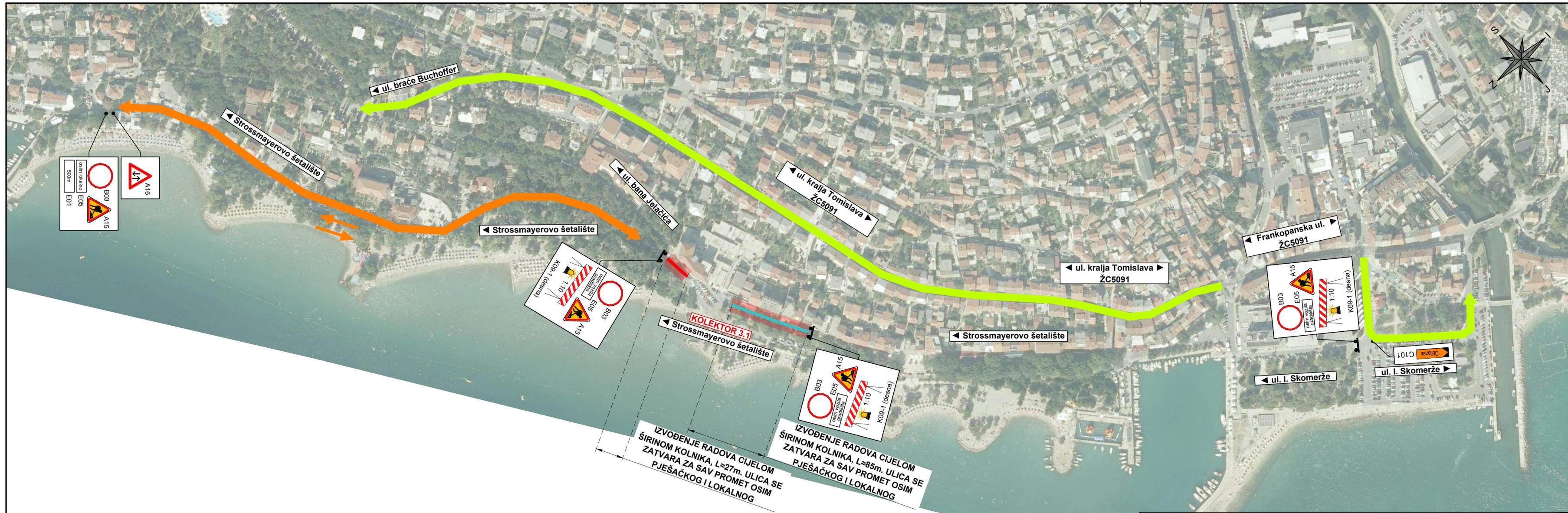
Dionicu izvođenja radova na kolektoru K3.1 u Strossmayerovom šetalištu potrebno je u cijelosti zatvoriti za promet zbog nemogućnosti izvođenja radova u jednom traku. Sanacija kolektora se izvodi metodom bez iskopa, te je radnim vozilima potrebno osigurati dovoljno prostora za izvođenje radova. Vrijeme izvođenja radova procijenjeno je 5 - 7 dana.
